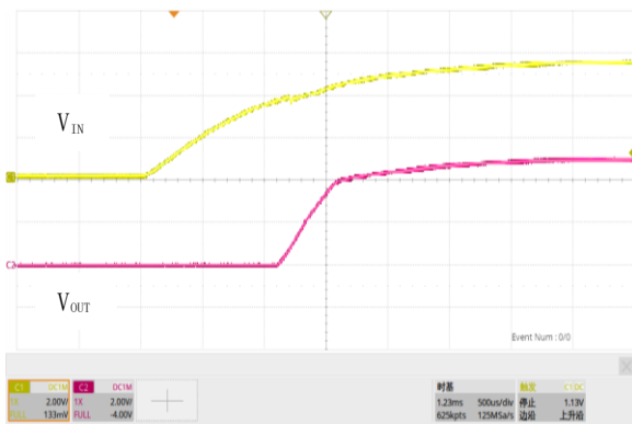
图 18. 软启动, V_{IN}=5.5V , V_{OUT}=5.0V , I_{OUT}=3A
