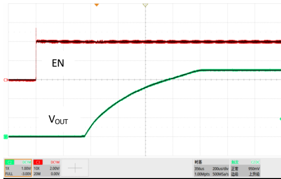
图 21. 软启动, V_{IN}=4.3V , V_{OUT}=3.6V , I_{OUT}=200mA
