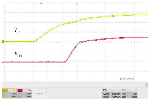
图 18. 软启动, V_{IN}=5.5V , V_{OUT}=5.0V , I_{OUT}=1.5A
