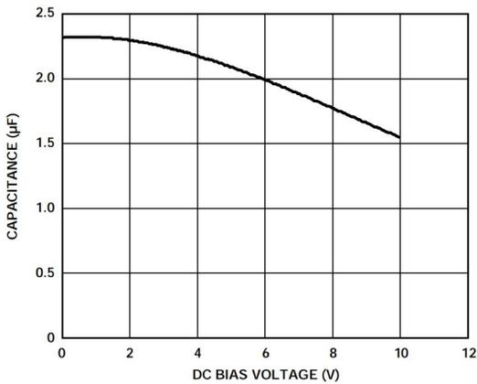
图 26. 电容与电压关系特性
