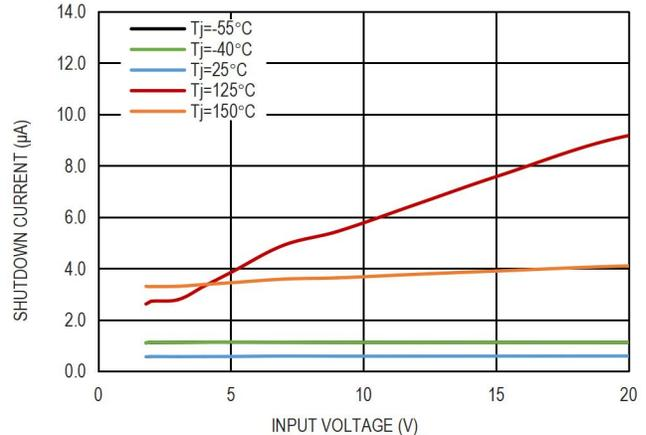
图 9. 关机电流和输入电压的关系
