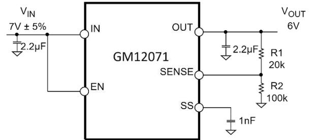
图 25. 典型可调输出电压应用原理图
