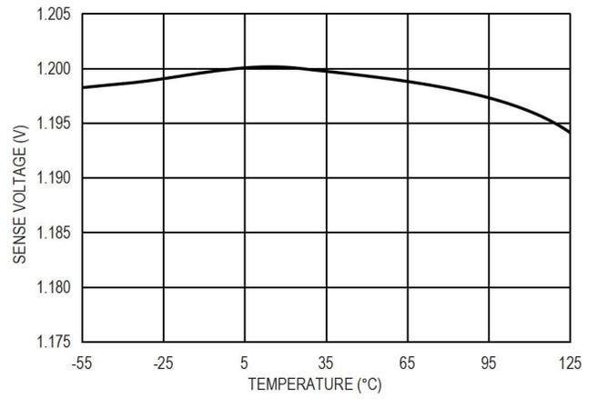
图 13. 1.2V SENSE 引脚电压精度
