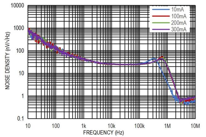
图 17. 输出噪声谱密度,  $V_{\text{IN}}=5\text{V}$ ,  $V_{\text{OUT}}=3.3\text{V}$
