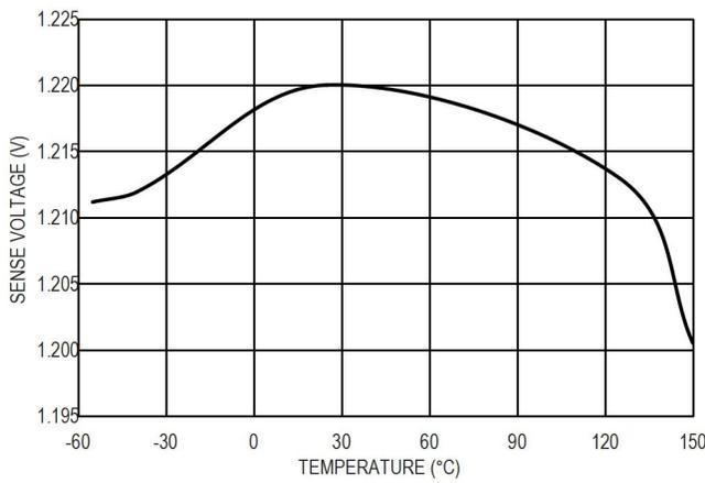
图 14. 1.22V SENSE 引脚电压精度
