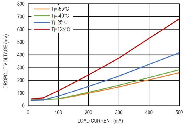
图 7. 5.0V 压差电压和负载电流的关系
