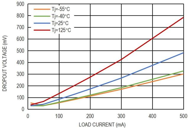
图 6. 3.3V 压差电压和负载电流的关系
