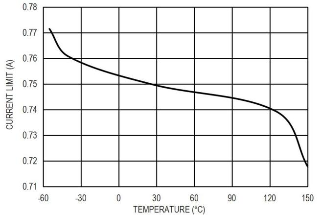
图 15. 输出限流值和温度的关系
