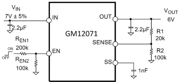
图 28. EN 引脚的典型分压器
