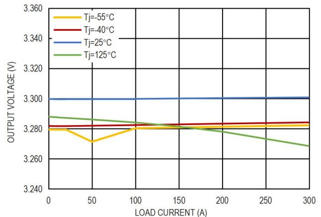
图 11. 3.3V 输出电压和负载电流的关系
