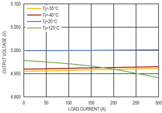
图 12. 5.0V 输出电压和负载电流的关系
