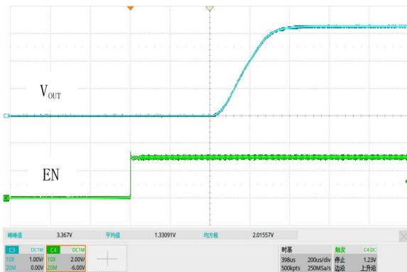
图 22. 软启动,  $V_{IN}=4.3V$ ,  $V_{OUT}=3.3V$ ,  $I_{OUT}=500mA$
