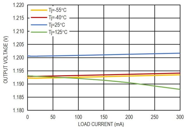
图 10. 1.2V 输出电压和负载电流的关系
