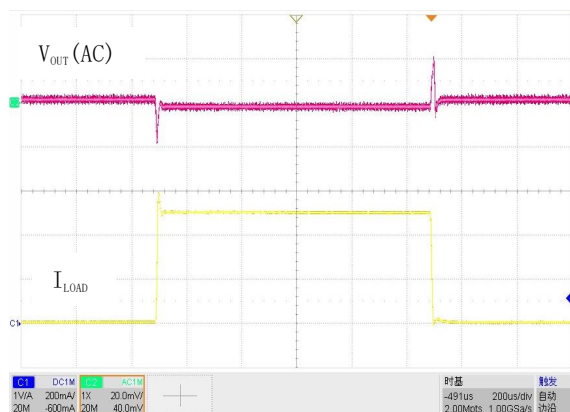
图 21. 负载瞬态响应, V_{IN}=1.2V , V_{OUT}=0.8V , I_{OUT}=1mA to 500mA
