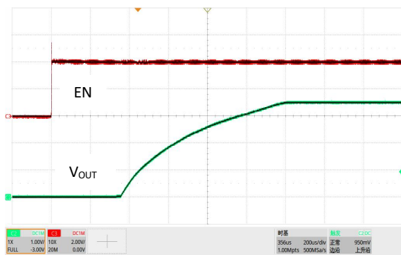
图 21. 软启动, V_{IN}=4.3V , V_{OUT}=3.6V , I_{OUT}=200mA
