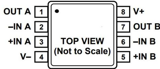
图 3. MSOP-8 和 SOP-8 引脚配置(顶视图)
