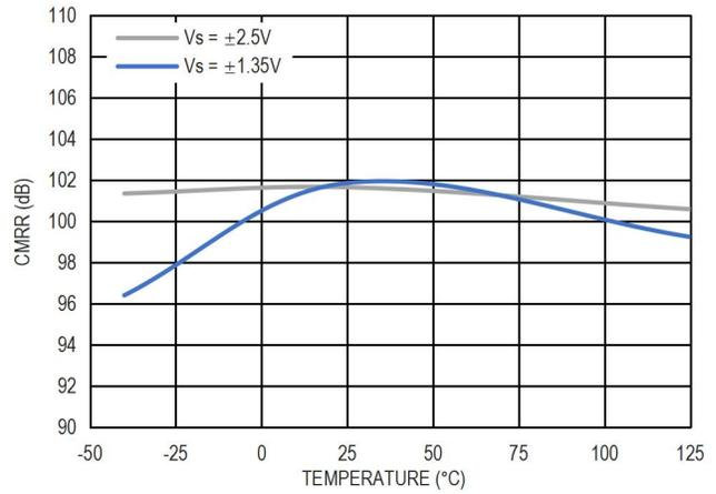
图 12. 大信号 CMRR vs. Temperature,  $V_{CM}=0V$
