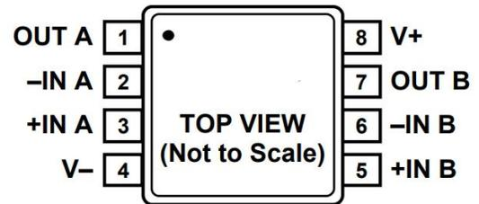
图 1. 8 引脚 MSOP 和 SOP
