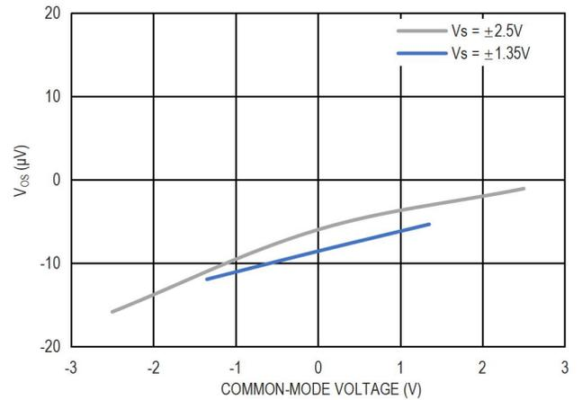
图 6. Input Offset Voltage vs. Common-Mode Voltage
