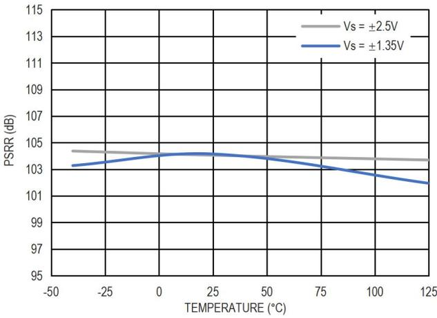
图 13. 大信号 PSRR vs. Temperature
