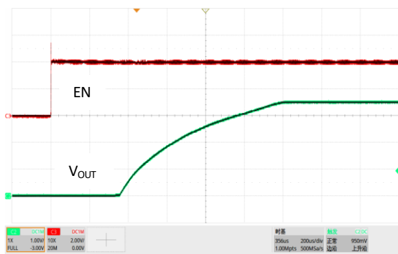
图 21. 软启动, V_{IN}=4.3V , V_{OUT}=3.6V , I_{OUT}=200mA
