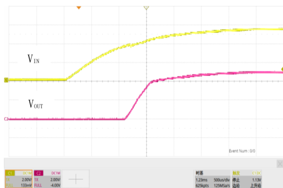
图 18. 软启动, V_{IN}=5.5V , V_{OUT}=5.0V , I_{OUT}=0.5A
