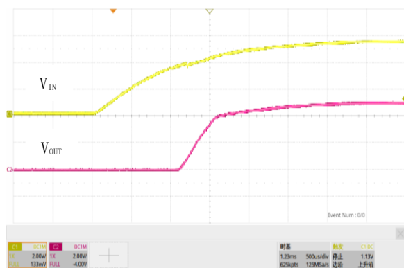
图 17. 软启动, V_{IN}=5.5V , V_{OUT}=5.0V , I_{OUT}=2A
