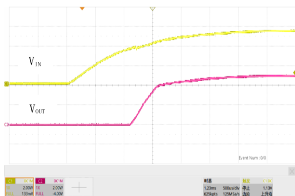
图 17. 软启动, V_{IN}=5.5V , V_{OUT}=5.0V , I_{OUT}=2A
