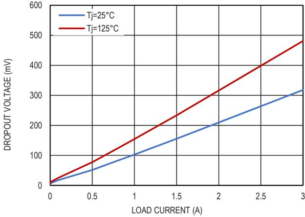
图 4. 压差电压和负载电流的关系
