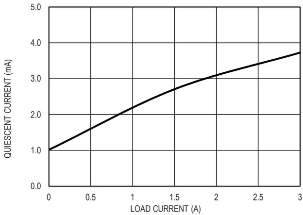
图 6. 静态电流和负载电流的关系
