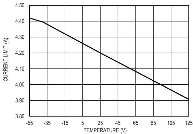
图 12. 输出限流值和温度的关系
