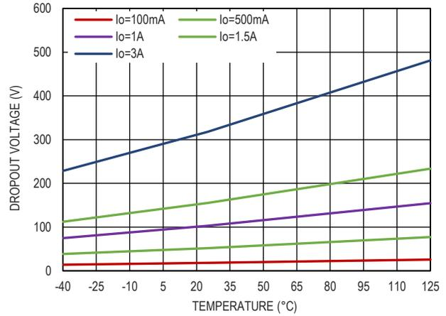
图 5. 压差电压和温度的关系
