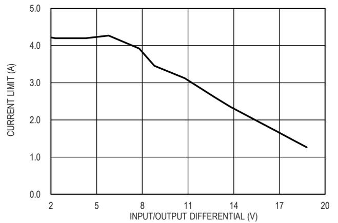
图 13. 输出限流值和输入输出压差的关系
