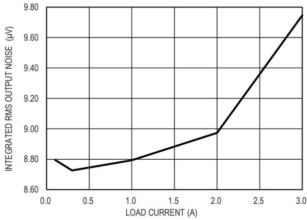
图 16. 积分 RMS 输出噪声,  $V_{IN}=5V$ ,  $V_{OUT}=3.3V$
