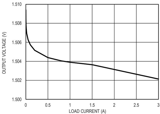
图 8. 1.5V 输出电压和负载电流的关系
