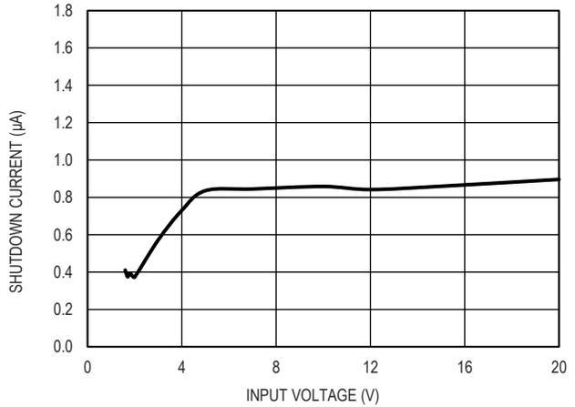
图 7. 关机电流和输入电压的关系
