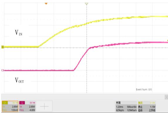
图 18. 软启动,  $V_{IN}=5.5V$ ,  $V_{OUT}=5.0V$ ,  $I_{OUT}=3A$
