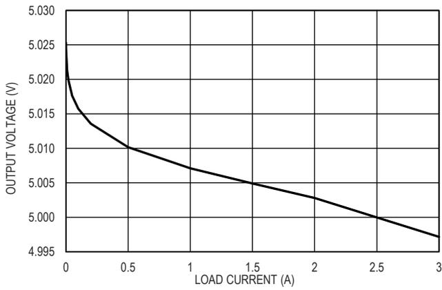
图 10. 5.0V 输出电压和负载电流的关系
