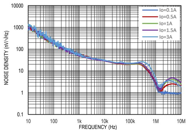
图 15. 输出噪声谱密度,  $V_{IN}=5V$ ,  $V_{OUT}=3.3V$
