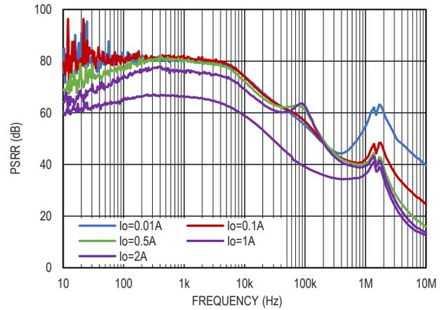
图 17. 电源电压纹波抑制比,  $V_{IN}=5V$ ,  $V_{OUT}=3.3V$
