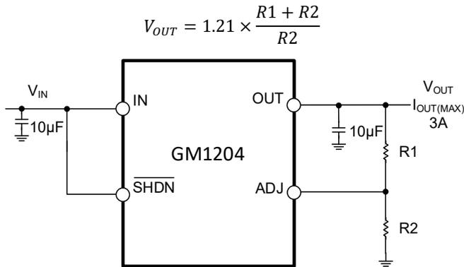
图 20. 由外部电阻决定的输出电压
