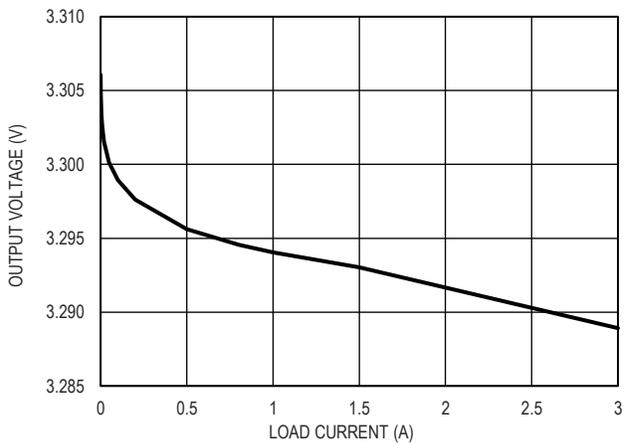
图 9. 3.3V 输出电压和负载电流的关系
