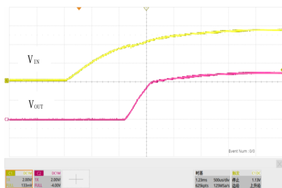
图 17. 软启动, V_{IN}=5.5V , V_{OUT}=5.0V , I_{OUT}=2A
