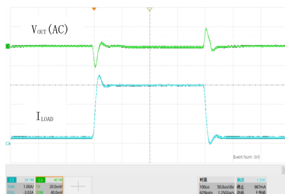
图 18. 负载瞬态响应, V_{IN}=2.8V , V_{OUT}=1.8V , I_{OUT}=0.1A to 1.5A
