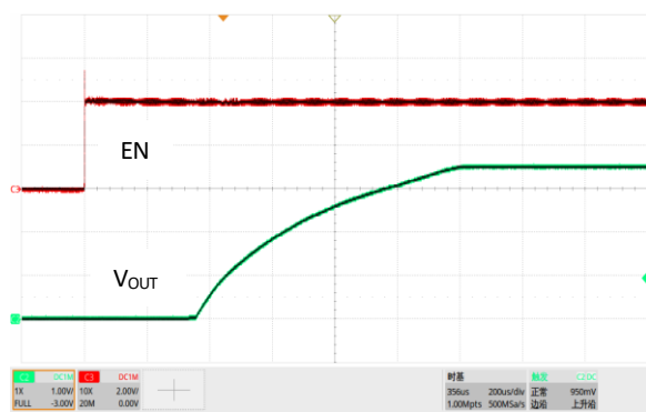
图 21. 软启动, V_{IN}=4.3V , V_{OUT}=3.6V , I_{OUT}=300mA
