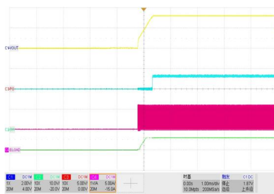
图 11. 启动波形, V_{out} = 3.3V , I_o = 3A
