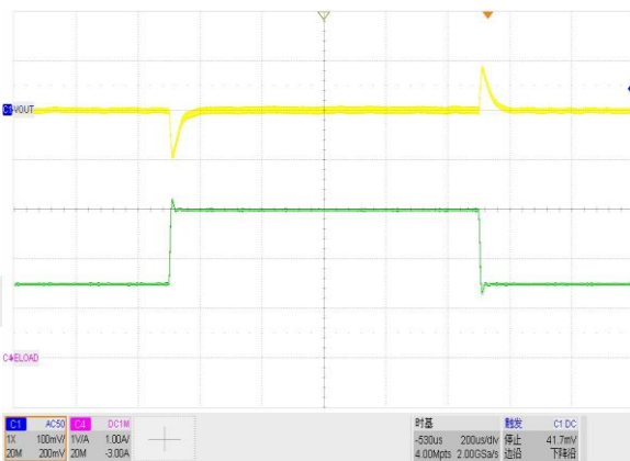
图 14. V_{out} = 1.2V , I_o = 1.5A 至 3A , FPWM 模式
