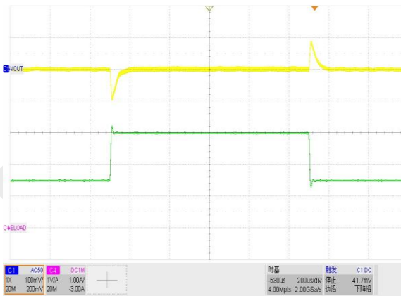
图 14. V_{out} = 3.3V , I_o = 1.5A 至 3A , FPWM 模式
