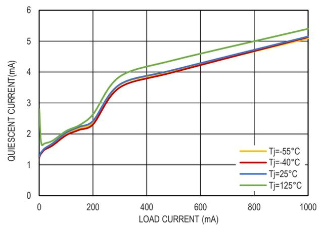
图 6. 静态电流与负载电流的关系
