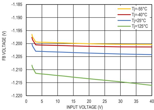
图 5. FB 引脚电压与输入电压的关系
