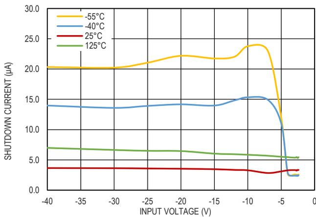
图 7. 关机电流与输入电压的关系
