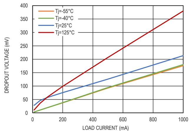
图 8. 压差电压和负载电流的关系
