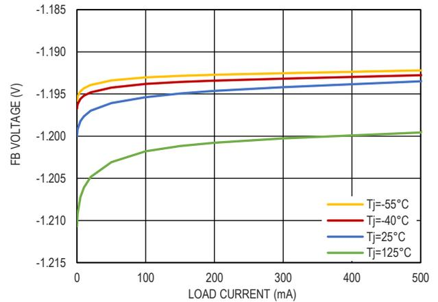
图 4. FB 引脚电压与负载电流的关系
