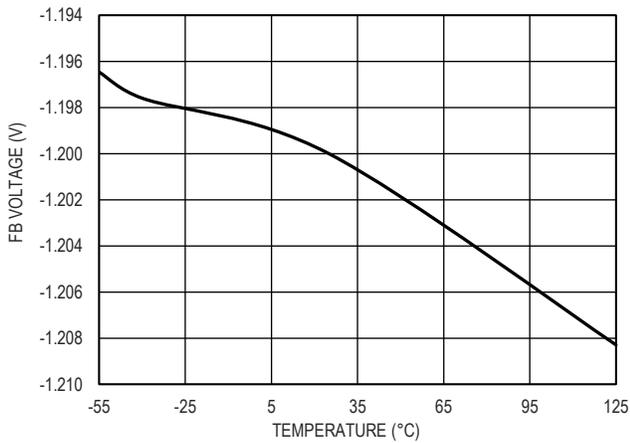
图 3. FB 引脚电压与结温 ( $T_j$ ) 的关系
