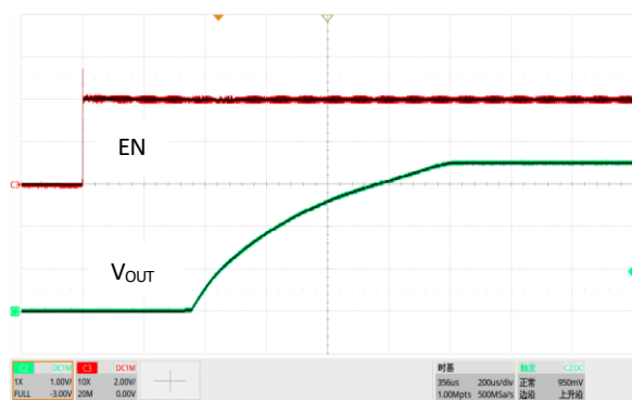
图 21. 软启动, V_{IN}=4.3V , V_{OUT}=3.6V , I_{OUT}=300mA
