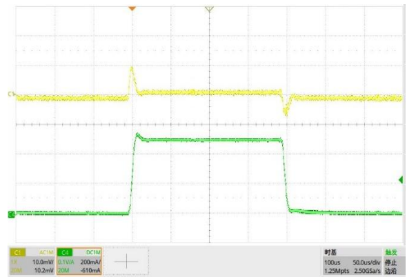
图 19. 负载瞬态响应, V_{OUT} = -5V , I_O = -10mA 至 -500mA
