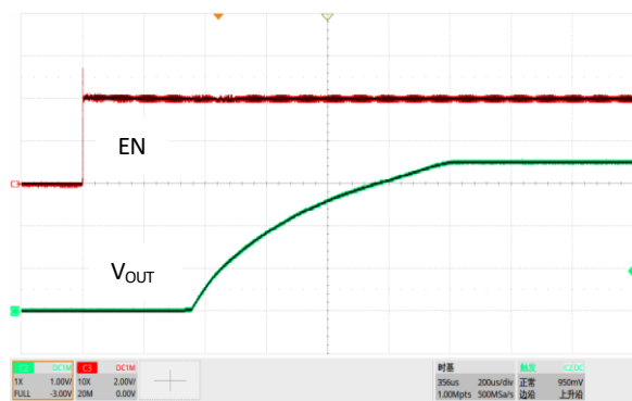
图 21. 软启动, V_{IN}=4.3V , V_{OUT}=3.6V , I_{OUT}=300mA
