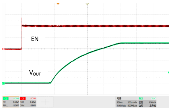
图 21. 软启动, V_{IN}=4.3V , V_{OUT}=3.6V , I_{OUT}=200mA
