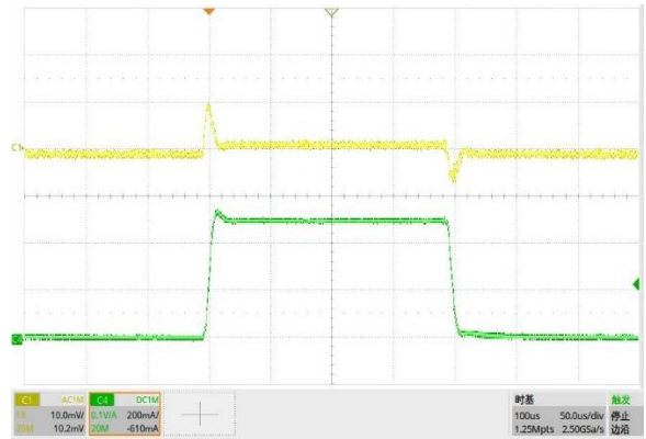
图 21. 负载瞬态响应, V_{OUT} = -5V , I_O = -10mA 至 -500mA
