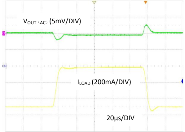
图 17. 负载瞬态响应, V_{IN}=-4.3V , V_{OUT}=-3.3V , I_{OUT}=10mA to 500mA
